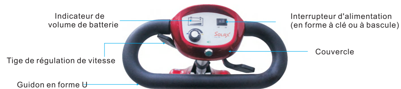
Figure de Panneau de contrôle de 2043
